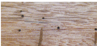
„Pinholes“ bei überseeischen Harthölzern
